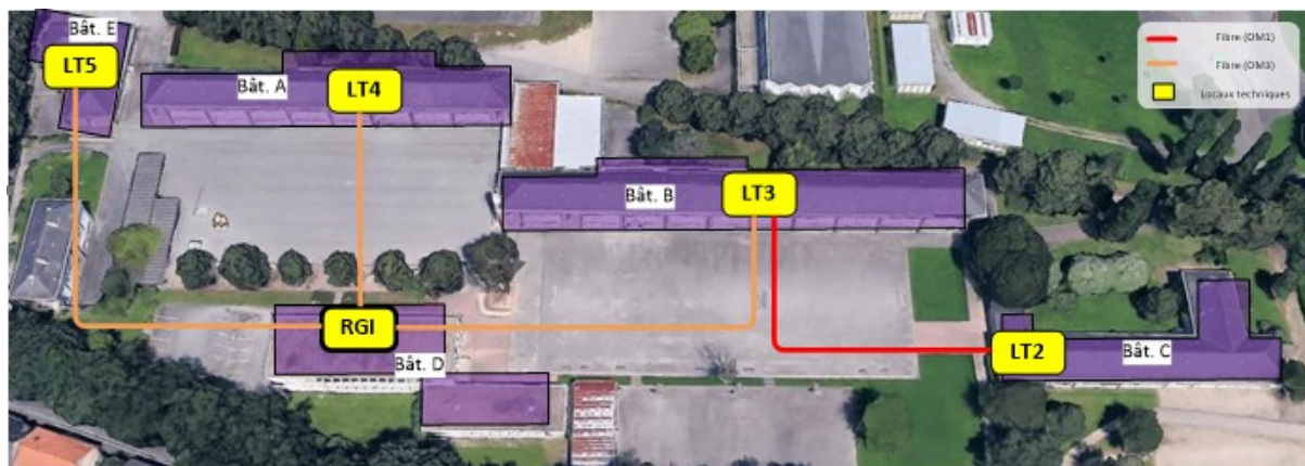
Figure 1 : vue topographique de la desserte interne d'un collège (câblage vertical).
